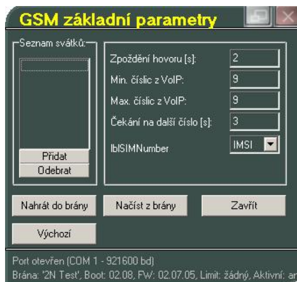
Obr. 35 – okno pro nastavení základních parametrů GSM
