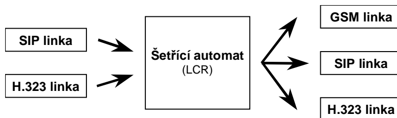
Obr. 24 – Směrování hovorů přicházejících na bránu z VoIP sítě
