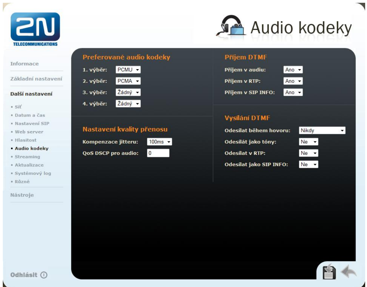
Obrázek 3.15 Nastavení audio kodeků
