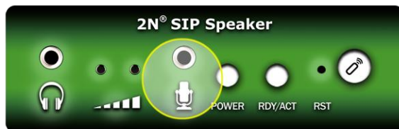
Obrázek 2.5 Připojení audio vstupu
