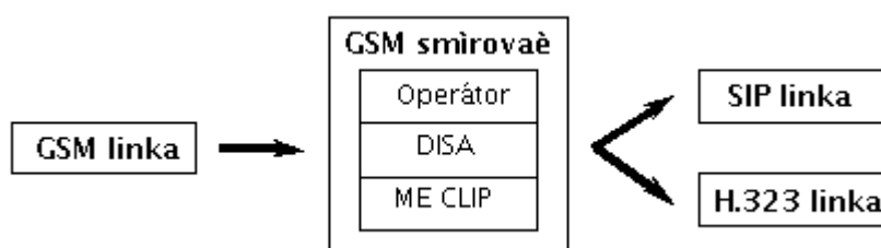
Obrázek : Směrování hovorů přicházejících na bránu z GSM sítě
