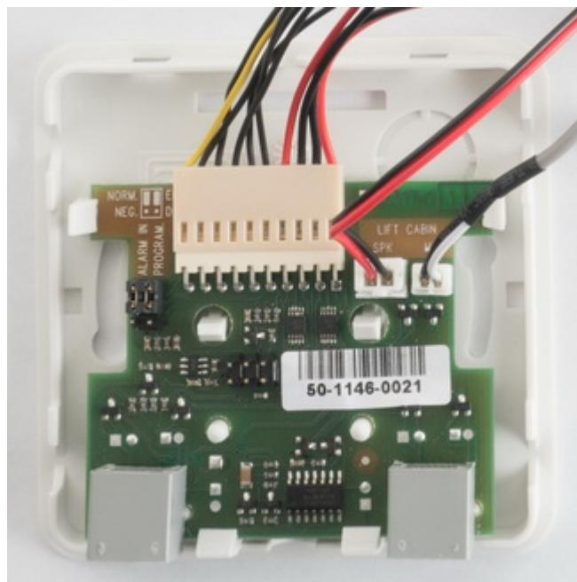
Na horním krytu výhybky musíme vylomit otvory pro protažené kabely. Poté můžeme výhybkou zakrytovat. Na boku výhybky jsou 2 konektory typu RJ12 pro připojení hlásek. Pomocí kabelu přiloženého k hlásce propojte hlásku s výhybkou.
