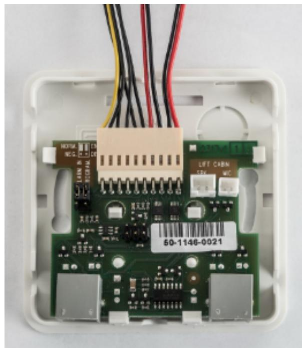
Ve výhybce zapojíme mikrofon a reproduktor z **2N® Lift1/ 2N® Singletalk**. Konektory pro připojení reproduktoru a mikrofonu jsou popsány (SPK a MIC). Vyjmuté jumpery nasadíme na propojky ve výhybce. Nastavení je úplně stejné jako u **2N® Lift1/ 2N® Singletalk** (nastavení je popsáno i na desce výhybky). Připojené kably protáhneme otvory.
